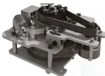
Vändkorsmekanism – kvalitetsbroms med kort svarstid.
